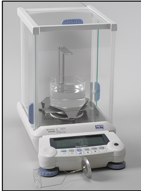
Figura 20: Balança e arranjo utilizado para a medida de densidade [45].
