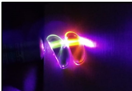
Figura 30: Fotografia da emissão das amostras com tempo de fusão de 75 minutos (esquerda) e 240 minutos (direita), quando excitadas por laser em 405 nm [Fonte: Autor (2023)].
